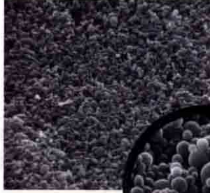
Milimetrenin binde birinden milimetreye kadar değişebilen boyutlarda hazırlanabilen mik- rokürelerin elektron mikroskobu ile çekilmiş fotoğrafı. Her bir kürenin içine et- ken madde yüklenmiştir.
