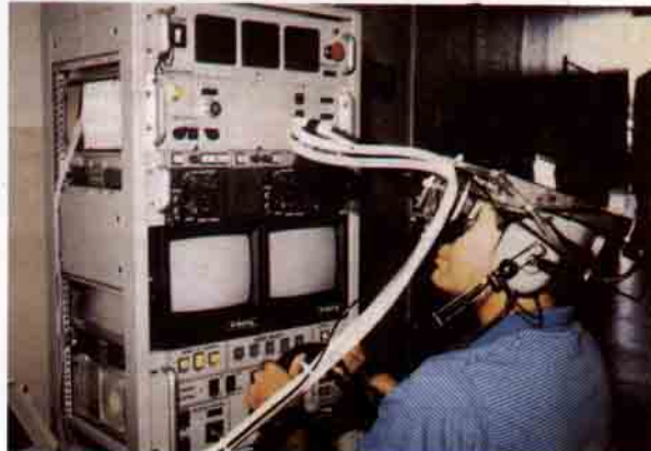
Teleoperatör jip: Uzaktan yönetilen bu savaş aracı, çok tehlikeli bölgelerde insansız olarak kullanılabilir. Jipe uzaktaki bir yerde komuta eden operatör, araç üzerindeki iki kameranın tespit ettiği görüntüleri, özel bir başlığa yerleştirilmiş iki ekrandan izleyebilir.
