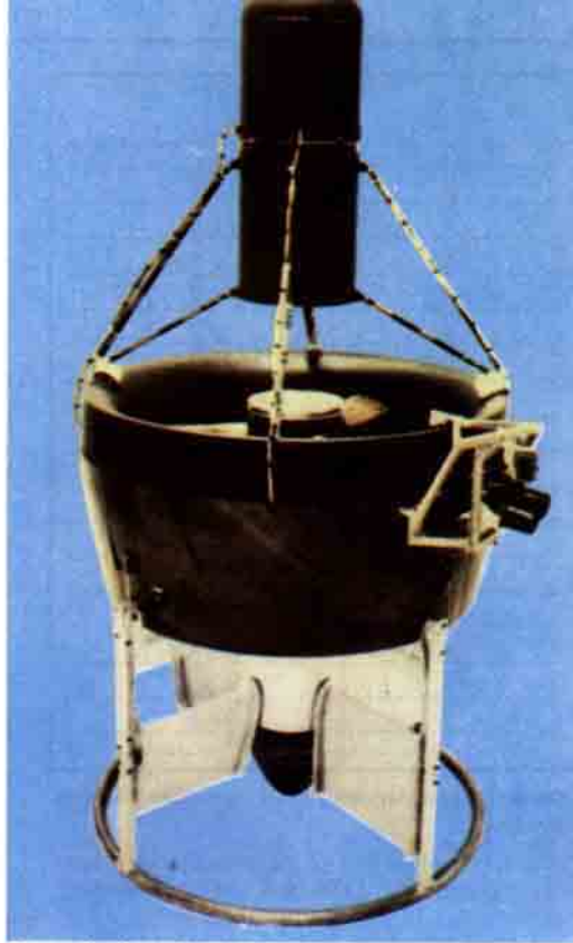
Uçan platform: Uzaktan kumanda edilen ve etrafı gözleyen kameralara sahip platform, operatörün geniş alanları kuş bakışı taramasına imkân verecektir.
