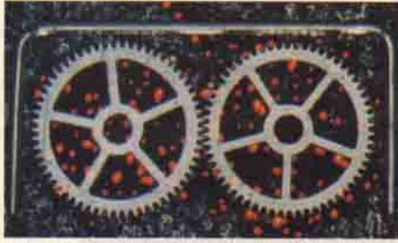
Mikromakineler için kullanıldığında X ışını litografisi, resimde boyutlarını gösterebilmek için çevrelerine bir kağıt ataca konulmuş dişlileri küçültülmüştür.
