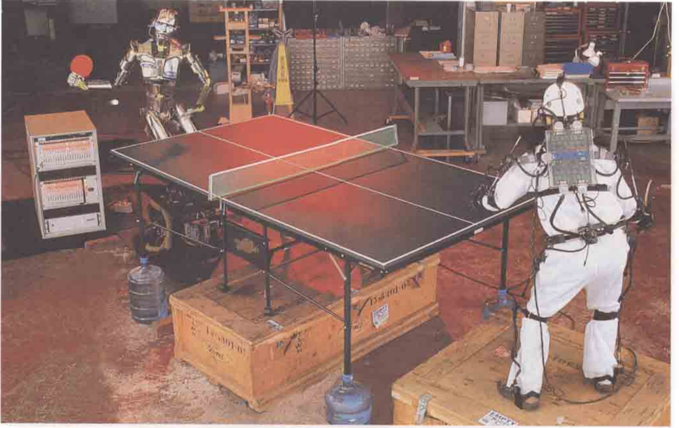
Operatörün üzerindeki sensörlerin algıladığı hareketler, SARCOS adlı bilgisayar tarafından yorumlanıyor ve robot da aynı hareketleri taklit ediyor. Robotun hareketlerinin çoğu hız ve düzgünlük açısından operatörünkülerden farksız ancak bu aşamada, karar vermek için bir insan beyninin yönlendirmesine muhtaç.
