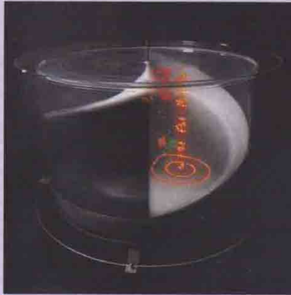
Üç boyutlu televizyon prototipi hava trafiğini hareketli ışık noktaları biçiminde gösteriyor
