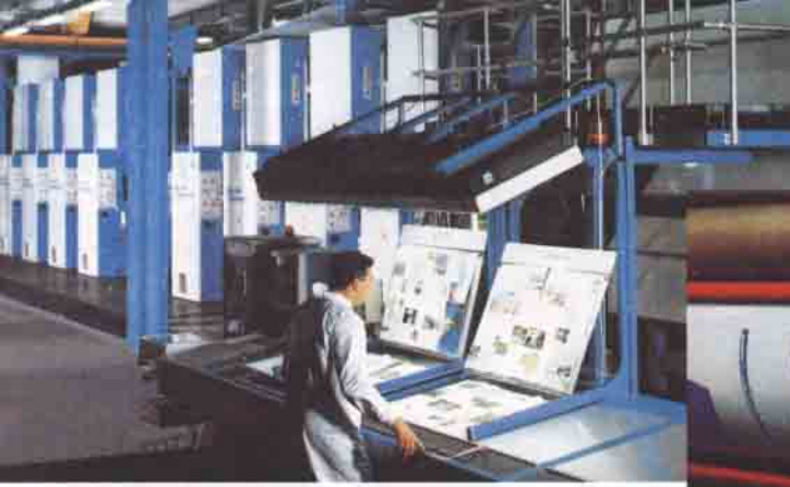
Baskı silindiri aklennmiş Toray baskı levhaları susuz ofset baskıda kuru baskı sonuçları elde edilmesine yarar. Susuz ofset baskıda fotoğraf kalitesi oldukça yüksek olur.
