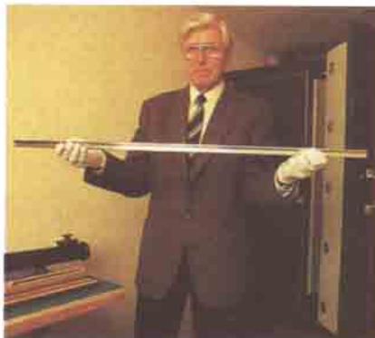
1889'da dökülen iridyumlu platin çubuk bir meridyenin 40 milyonda birine eşit.
