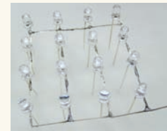
Şekil 10: Hazır durumdaki LED düzlemi
