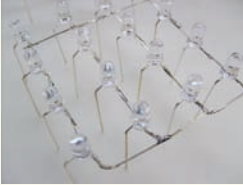
Şekil 13: LED gruplarını lehimleme
