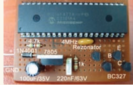
Şekil 19: Bakır plaketteki yerleşim planı
