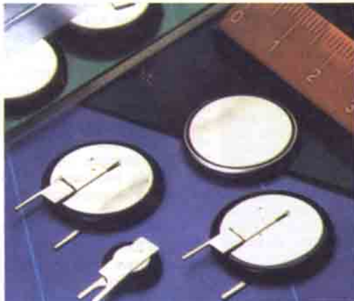
Güç kesilmesi durumunda bilgisayarın hafızasını koruyan küçük piller. Bunların ilk lityum-plastik tipleri piyasaya çıktı.
