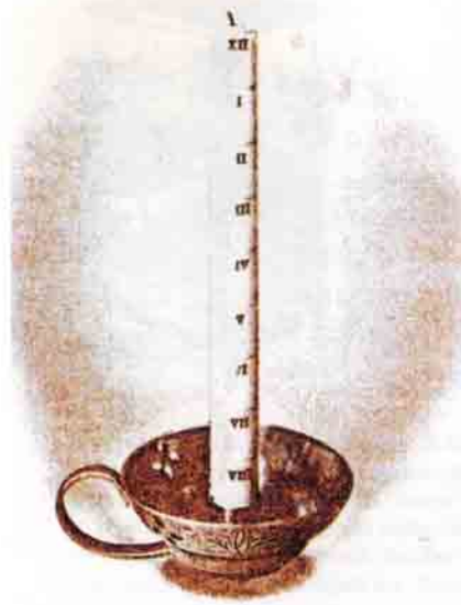
Şimdiye kadar yapılmış saatlerin belki de en basiti olan, Kral Alfred tarafından tasarlanmış bu ateş saati, üstündeki ölçekte mum yandıkça geçen süreyi gösteriyor.
