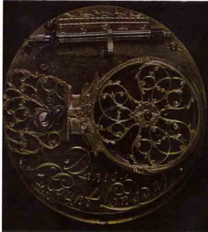
Balans yayının kullanılmaya başlamasıyla yapılan ilk cep saatlerinden.
