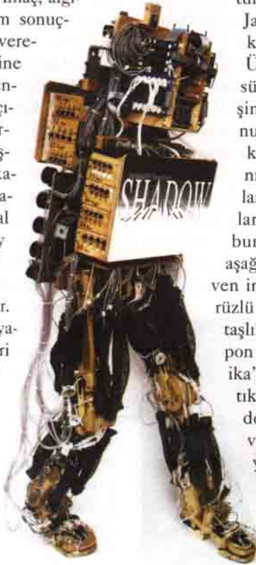
Shadow da P3 gibi 1,6 m boyunda. İskeletise tahtadan yapılmış.
