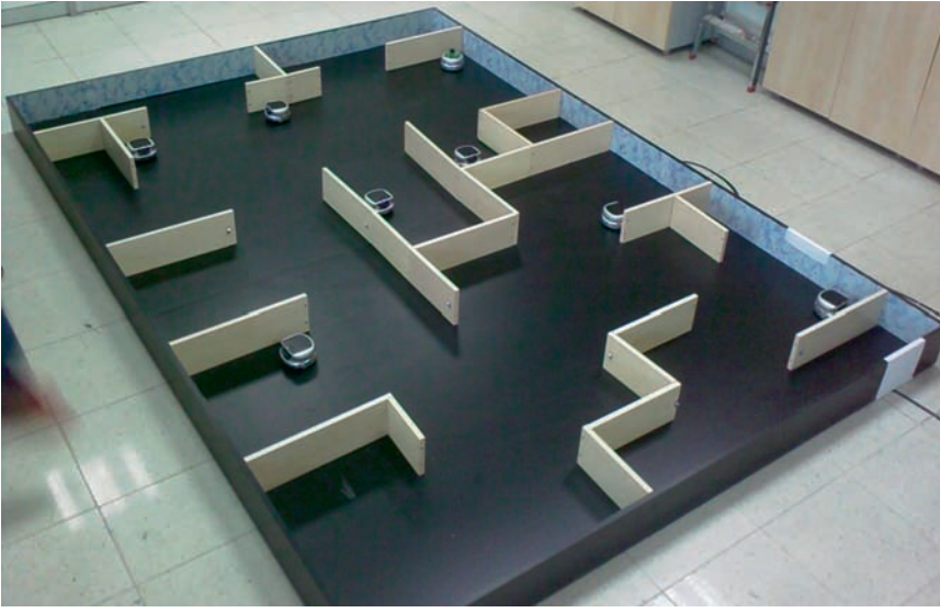
Laboratuvar ortamında kurulmuş temsili bir bina içi karmaşık ortamda arma yapan 8 adet Khepera 3 tipi deneysel mini robottan (13 cm çapında) oluşan robot sürüsü. Robotlar üzerlerindeki kızılötesi ve sesötesi algılayıcılar ve eklenebilen kameralar ile çevreyi algılayabilir, çevrenin haritasını çıkarabilir ve kendini bağlı olarak konumlayabilir. Ayrıca üzerlerinde bulunan telsiz ethernet haberleşme üniteleri ile aralarında ve erişim alanında bulunan erişim noktaları ve bilgisayarlar ile haberleşebilir.
