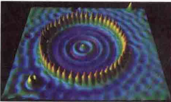
Zenon atomlarıyla oluşturulmuş havuzda elektron dalgaları (TTM görüntüsü)
