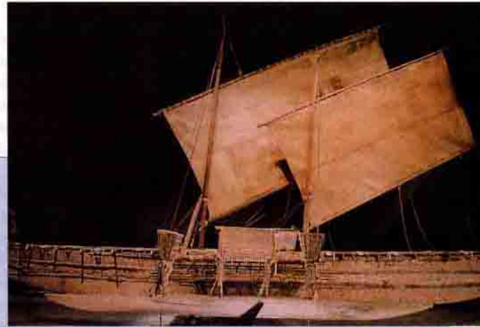
Şekil 2: Para-Mikronezya açıkdeniz yelkenlisi. Kabasortu armalı olup uzakölü seferleri için düzenlenmiş bu tekneler eli mürettebat ile yola çıkabiliyordu. Bu resimde görülen tekne, tipinin son örneğiymiş ve 1904 yılında Berlin'e getirildi. Tam boyu 15 metre civarındadır. (Museum für Völkerkunde, Staatliche Museen zu Berlin, Preussische Kulturbesitz)
