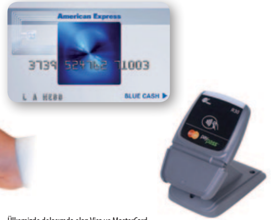
Ülkemizde dolaşımda olan Visa ve MasterCard temassız kredi kartlarında mikroışlemci ve anten gözükmezken, American Express kartında görünüyor.
