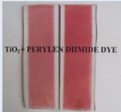
Şekil 4. Nanomorfolojik yapıda saydam TiO 2 üzerine absorblanmış perilendiimid boya maddesi (Yazılar cam tabakanın altında).
