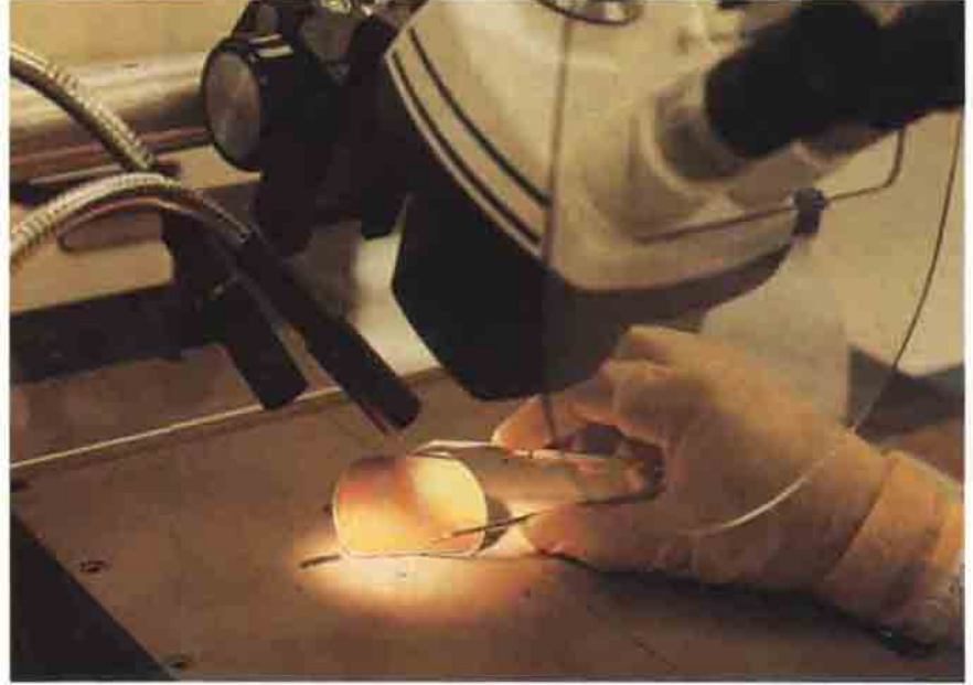
Serigrafik Baskı yapılmış bir ekranın mikroskop altında kontrolü edilmesi
