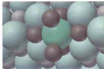
Tuz kristalinin bir kuantum işlemci olarak kullanılması yöntemi. Böyle bir işlemci tüm kuantum sistemlerinin taklit edilerek incelenmelerine olanak sağlayabilir.
