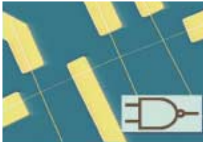
Hu Yuang ve ekibince altın nanoteller kullanılarak gerçekleştirilen mantık devresi
