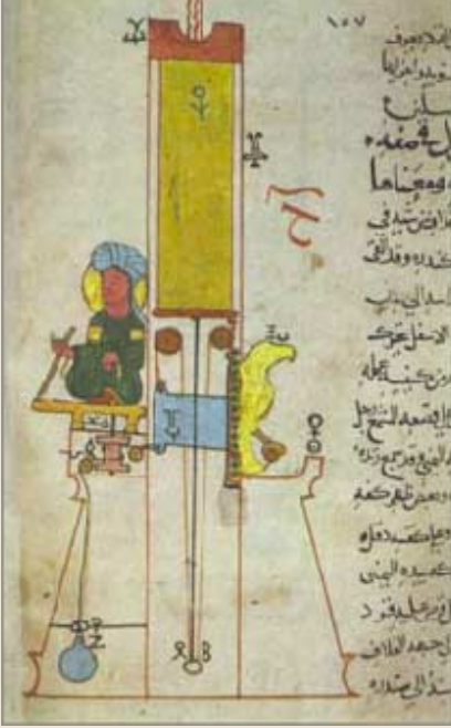
Ebû'l-İz El Cezeri'nin mumlu saat otomati (solda) su otomati (üstte)
