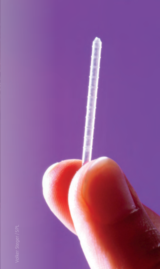
Kemikleri onarmak için kullanılan, biyocamdan üretilmiş bir ortopedik çivi
