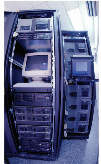
Şekil 7. Parallelleştirme sayesinde elektromanyetik problemlerin çözümleri birden çok işlemci arasında paylaştırılabilir. Ancak, bu problemlerin doğru çözümleri için işlemciler arasında haberleşmelerin yapılması gerekmektedir. Sağda, çok büyük elektromanyetik problemlerin çözümleri için BiLCEM'de kurulan 64 ve 128 çekirdekli bilgisayarlar gösterilmiştir. Her iki sistemde de çekirdek başına 4 gigabyte bellek bulunmaktadır. İşlemciler arasındaki haberleşmelerin yüksek verimle yapılabilmesi için Infiniband ağ anahtarları kullanılmaktadır.
