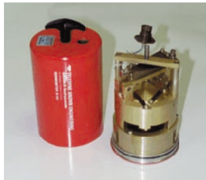
Özel amaçlı sismograflar, yerel sarsıntıların ölçülmesi için taşınabilir olarak yapılır (sağda). Dünya üzerindeki binlerce sismograf deprem araştırma merkezlerine radyo-linklerle bağlıdır (üstte).
