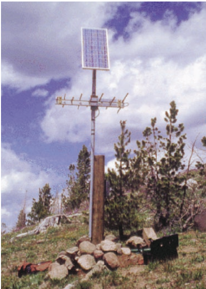
Özel amaçlı sismograflar, yerel sarsıntıların ölçülmesi için taşınabilir olarak yapılır (sağda). Dünya üzerindeki binlerce sismograf deprem araştırma merkezlerine radyo-linklerle bağlıdır (üstte).
