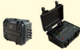
Binanın doğal titreşim frekansında meydana gelen değişiklikler kaydedilerek yorumlanmak üzere uzmanlara gönderiliyor.
