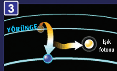
3. Elektron daha da düşük bir enerji düzeyine inerek bir foton salıyor.
