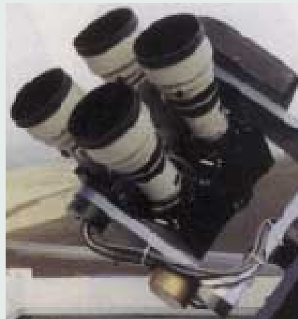
Gama ışın patlamalarının optik yankılarını gözleyen LOTIS, bir platforma yerleştirilmiş 4 teleobjektiften oluşuyor.
