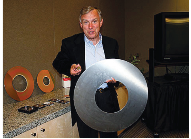
Soldaki 1 inçlik modern sabit disk plakası, bundan 50 yıl öncesine ait 24 inçlik sabit disk plakasından 80 bin kat daha fazla veri depolayabiliyor.***
