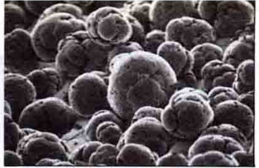
tabaka temizlenmiş ve nikelin reaktivitesi arttırılarak, mükemmel bir katalizör haline getirilmiştir.
