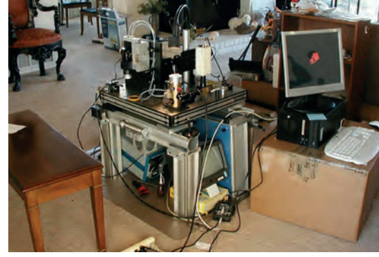
Betzig'in Harald ile birlikte oturma odasında inşa ettiği ilk PALM mikroskop
