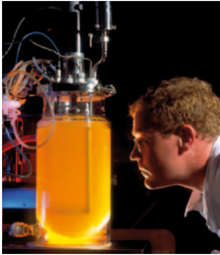
Mikropların endüstriyel ölçekte üretilmesini sağlayan küçük bir fermentör. Resimdeki araştırmacı E. coli adlı mikroplar yardımıyla, bir uyuşturucu olan morfini ağır kesici bir ilaç olan "hydromorfine" dönüştürüyor.
