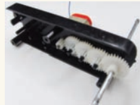
Şekil 7: Dişli çarkların sökülmesi
