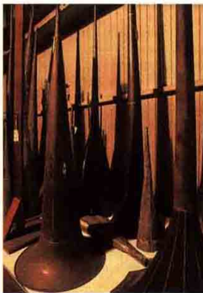
Kullanılan gereçlerden örnekler. İlk fonografı yaratırken denediği değişik boylarda borular.
