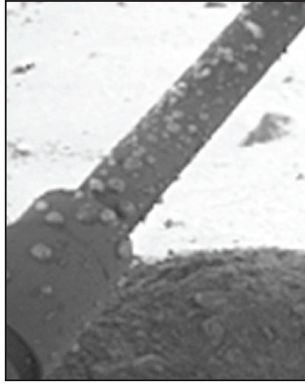
Phoenix'in iniş aracının ayaklarındaki destekleyicilerin üzerinde küçük kürecikler görülüyor. Bunların iniş sırasında sıçrayan su damlacıkları olabileceği düşünülüyor.
