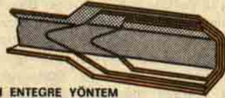
ŞEKİL 3. YARI ENTEGRE YÖNTEM İLE HAZIRLANMIŞ BİR KIRIŞ BAŞLIĞI.
