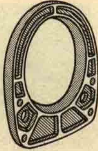
ŞEKİL 1. ENTEGRE YÖNTEM İLE HAZIRLANMIŞ DÖVME BİR ÇERÇEVE.
