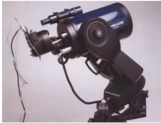
Değişen yıldız gözlemi yapmak, gama ışını patlamalarını gözlemlemek ya da Güneş-dışı gezegen keşfedebilmek için gereken donanım: Teleskop ve CCD kamera. Kuyruklu yıldız, nova ya da süpernova keşfetmek içinse yalnızca bir teleskop yeterli.
