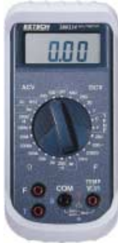
Multimetre, ac, dc voltaj, akım ve direnç ölçümünde kullanılır
