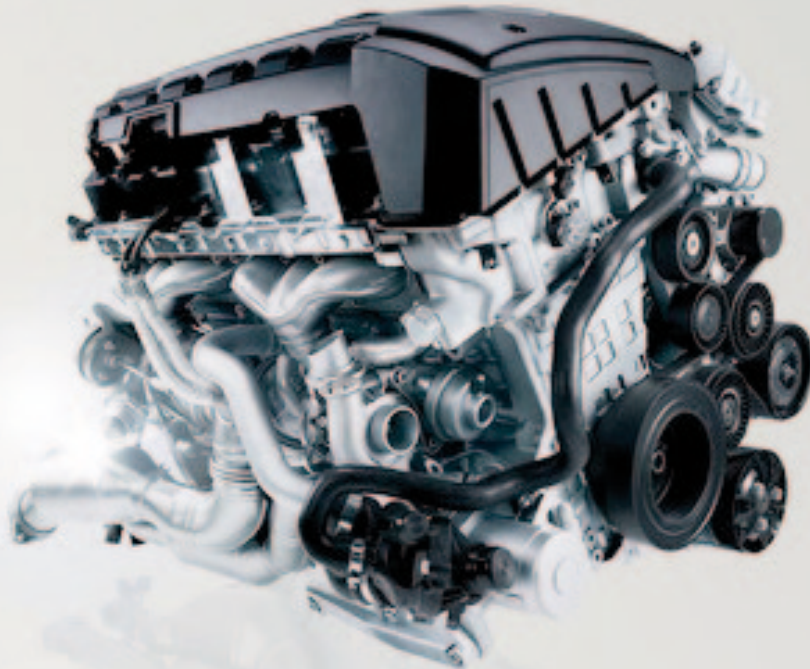
BMW magnezyum-alüminyum kompozit motor bloğu
