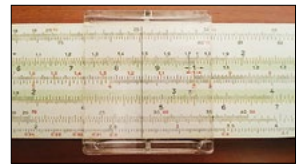
Sürgülü cetvelde 1,73x2,74 işleminin sonucu olarak alttaki yeşil bantın hemen altındaki beyaz sıradaki sayıyı 4,74 olarak okuyoruz. Böylece 1,73x2,74=4,74 sonucunu hemen bulduk.
