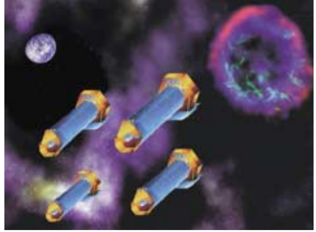
Sağ üstte: Birbirine bağlı 3.5 metre çaplı dört teleskoptan oluşan Kayasal Gezegen Bulucu, uzaklığı 50 ışık yılı'na kadar olan Yer benzeri gezegenleri görebilmemize olanak tanıyacak. Yanda: Bu canlandırma, yaklaşık 33 ışık yılı öteden Güneş Sisteminin TPF'ye nasıl görüneceğini gösteriyor. Oklar, Venüs, Yer ve Mars'ı gösteriyor. Solda: Kara delikleri incelemek üzere yörüngeye yerleştirilecek Constellation-X gözlemevi, birlikte çalışan 4 X-ışını teleskopundan oluşacak.
