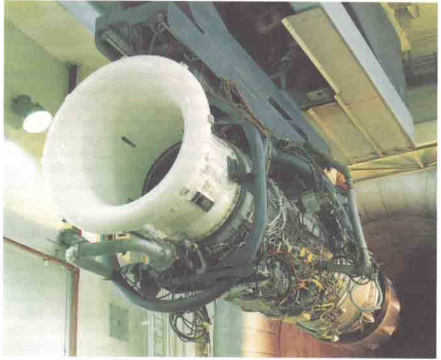
Test merkezinde motorun test edildiği bölüm görülüyor. Burada 45 ton tepkiye kadar olan bütün motorlar test edilebiliyor.
