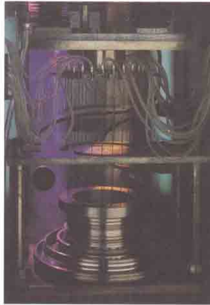
Tüplü elektro kimyasal derin delik delme (STEM)
