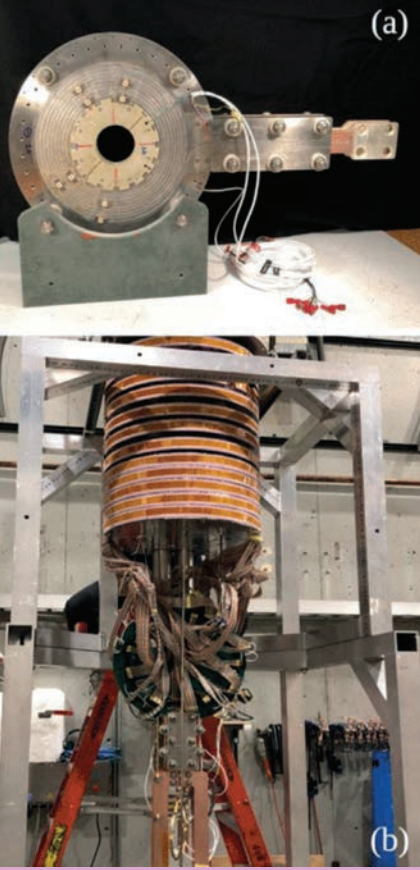
Süperiletken mıknatıs (a), 15 K sıcaklıkta yapılacak testler için hazırlanmış mıknatıs (b).
