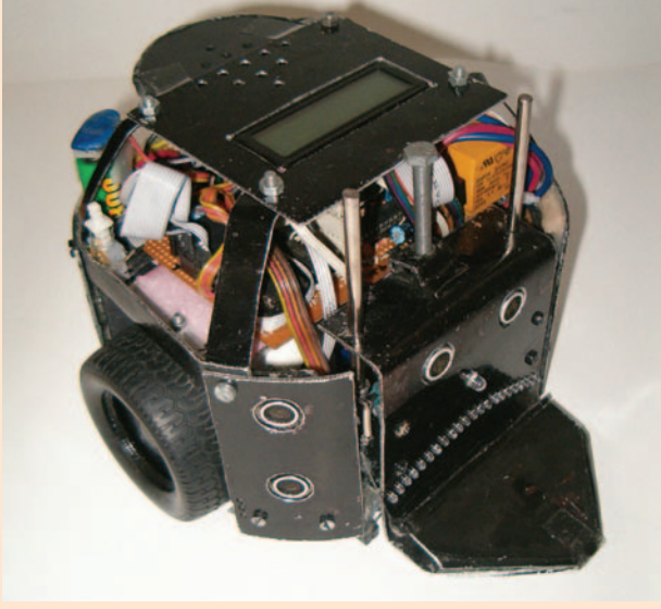
Şekil 1 : Ultrasonik sensörler kullandığım sumo rotların "Kara Murat" ve "Battal"
