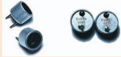
Şekil 3 : Ultrasonik uzaklık ölçümünde kullanılan 40 KHz lik alıcı ve verici sensör çiftleri
