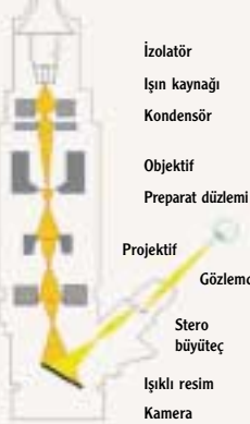
Bir elektron mikroskobunun yapısı
