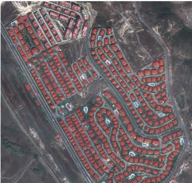
Yapay zekâ ile görüntüden otomatik olarak binaların bulunması (kırmızı çizgiler bina sınırları)
