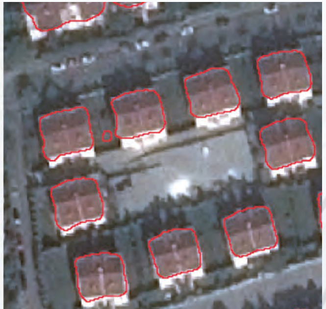
Yapay zekâ ile görüntüden otomatik olarak binaların bulunması (kırmızı çizgiler bina sınırları)
