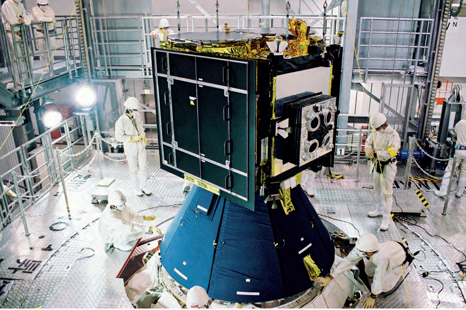
Hayabusa'nın devamı Hayabusa 2 adlı uydun Tanegashima Uzay Merkezinde H-IIA roketine yüklenirken. Sağ tarafta uydunun dört adet ızgaralı iyon motoru görülüyor.
