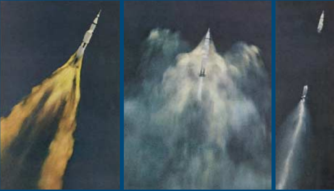
Apollo 11'i taşıyan Saturn V roketi, 16 Temmuz 1969'da saat 14:32'de (GMT) Florida'daki Kennedy Uzay Üssü'nden fırlatıldı. Roketin birinci aşaması 2 dakika 40 saniyede Saturn V'yi 67 km yüksekliğe götürdükten sonra beyaz bir duman çıkararak roketten koptu. İkinci aşamanın motorları çalışmaya başladı. İkinci aşama da roketi 6,5 dakikada 175 km yüksekliğe taşıdı ve sonra o da ayrıldı. Üçüncü aşamaysa Apollo 11'i, 28 000 km/saatlik bir hızla Dünya'dan uzaklaştırdı.
