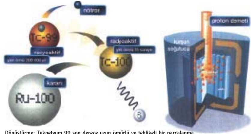
Dönüştürme: Teknyum 99 son derece uzun ömürlü ve tehlikeli bir parçalanma ürünü. Ancak, bir nötron eklenmesiyle tümüyle zararsız hale geliyor. Bu işlem, sıvı kurşunla soğutulan dönüştürme reaktöründe gerçekleştiriliyor (sağda).
