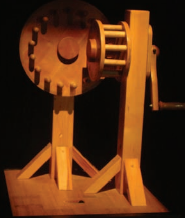
Dişli çarklar: Tek bir kolun hareketiyle birden fazla çarkın birbirini hareket ettirmesi ilkesine dayanıyor.
