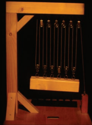
Palanga: Birden fazla makaranın kullanılması sayesinde ağırlığı kaldırmak için harcanan kuvvet azalıyor.
