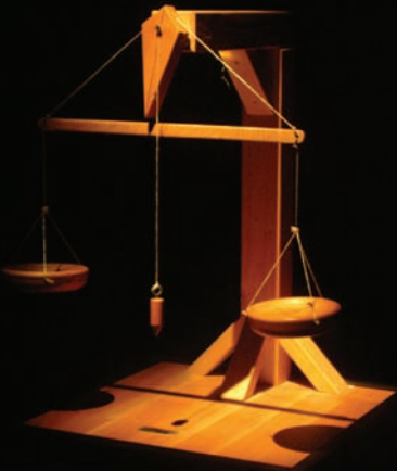
Nemölçer: Terazinin kefelerinden birine pamuk diğerine de eşit ağırlıkta balmumu yerleştiriliyor. Belirli bir süre sonra havadaki nemi emerek ağırlaşan pamuğun yarattığı sapmanın ölçülmesiyle, havadaki nem oranı hakkında bilgi sahibi olunuyor.
