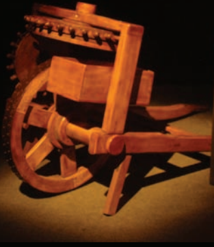
Odeometre: Tekerleğin dönme hareketi birbirine bağlı iki dişli çarkı hareket ettiriyor. Tepedeki dişli çark, her bir tam turda, en üstte yer alan haznenin içindeki taşlardan birinin yandaki kutuya düşmesini sağlıyor. Böylece, gidilen mesafe ölçülüyor.
