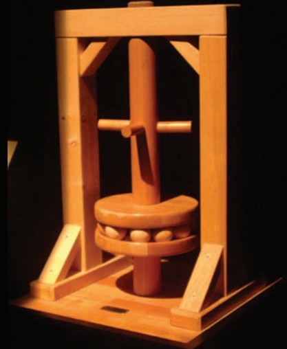
Rulman: Yüzeyler arasındaki sürtünme etkisi, oyukların içinde yer alan bilyeler sayesinde azaltılıyor.
