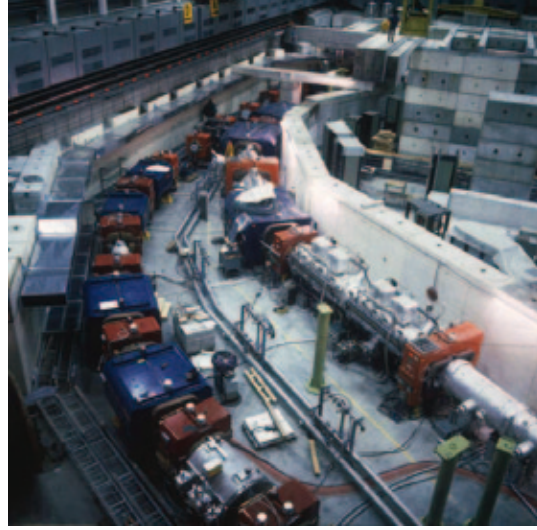
CERN'de karşı-hidrojen yapılması için çalışan AC yani karşı-proton alımcısı ve AA yani karşı-proton toplayıcısı makineleri gözükmekte.
