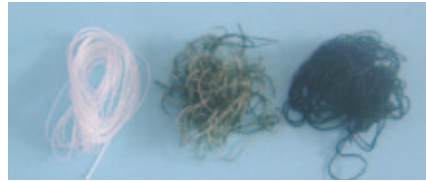
İletken polimerlerden yararlanılarak iletken lifler hazırlanabilir.
